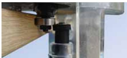
Адаптер для пылеудаления с системой торможения подшипника.
