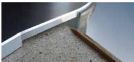
Одновременная обработка заготовки по радиусу кромки и заподлицо.
