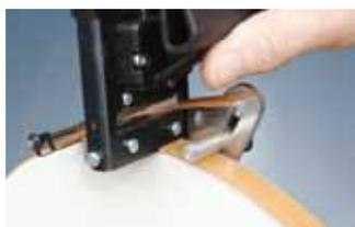
Верхняя кромка заводится в зазор подрезателя.
