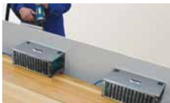
Возможно закрепление больших заготовок в вертикальном положении.
