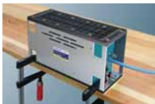
На неровных поверхностях вакуумный держатель можно зафиксировать с помощью струбцин.
