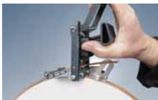
Простая установка подрезателя в нужное положение для подрезки свеса кромки.
