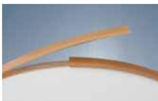
При оклейке круглой заготовки, кромка должна идти в нахлест.
