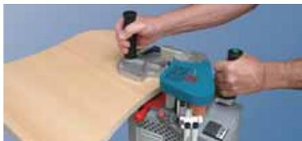
Облицовка прямолинейных и криволинейных заготовок.
