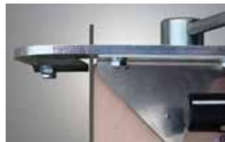
Точная подрезка кромки углов в 90°....
