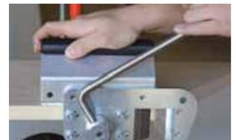
Ширина кромки макс. 50мм, толщина кромки до 3 мм.
