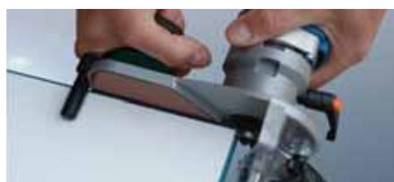
Выдвижной упор для деликатной обработки торцов кромок на угловых соединениях.
